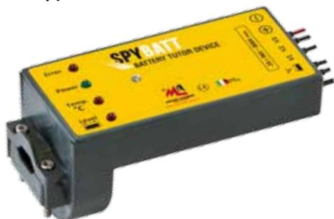
Quattro led tengono costantemente aggiornato l'utilizzatore su eventuali anomalie. I dati vengono scaricati tramite una porta mini USB, e l'interfaccia software è strutturata su tre livelli:
